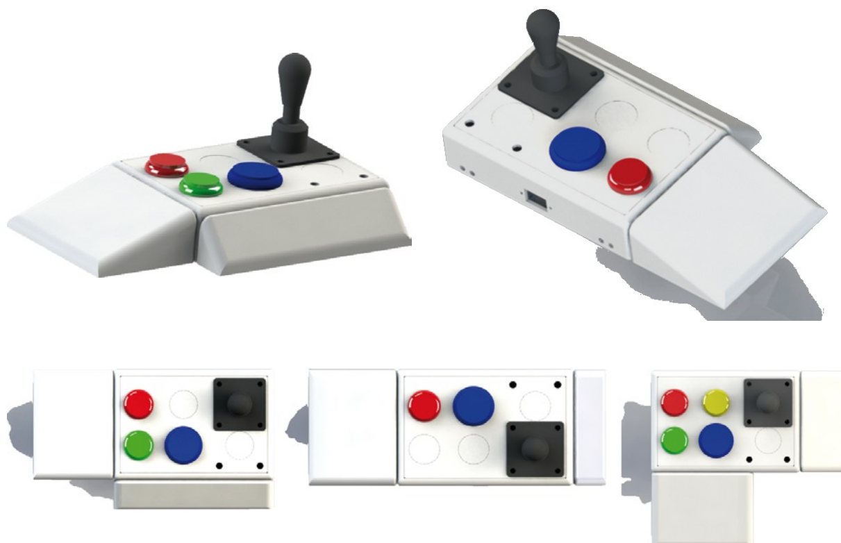
Figura 1. Diseño final de EASYMOUSE
